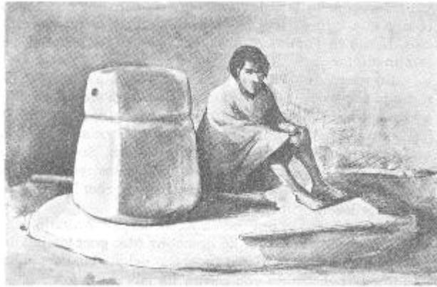
UN "MARAY" O "MARAN", pesado molino incaico para moler minerales en bruto. De Cobres, N.O. argentino, según Eric Boman. El dibujo muestra su tamaño. Estos grandes molinos servían, balanceándolos, para moler los minerales de cobre, plata y estaño, etc.
